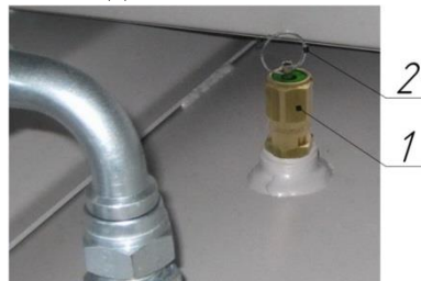
Рисунок 9 – Клапан предохранительный пружинного типа
